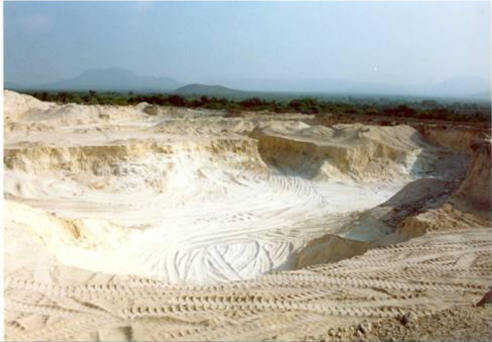
Proyecto El Tajo. Banco de extracción de arcilla cuarzo-feldespática.
